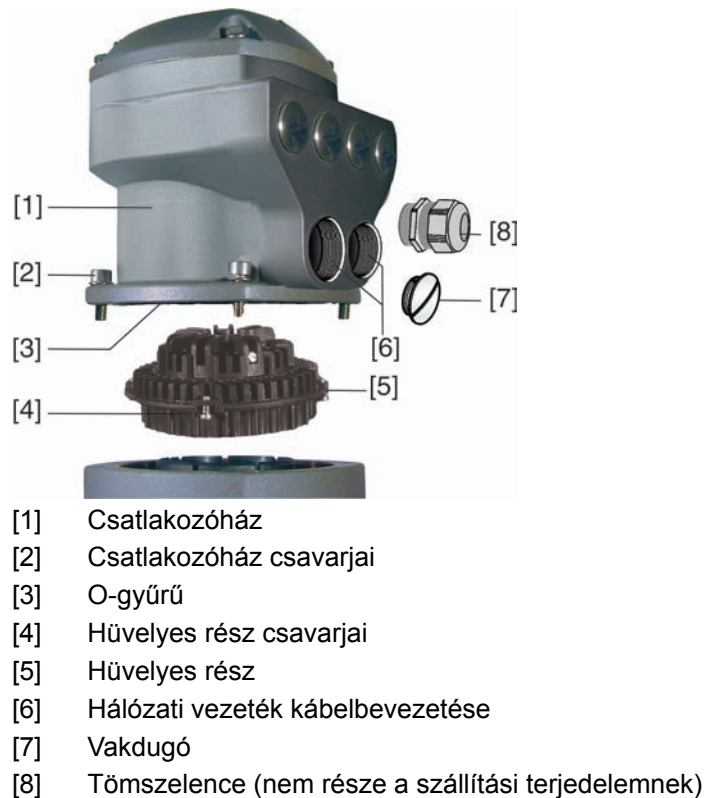
Kép 16: AUMA dugós körcsatlakozó, SD-Bus
