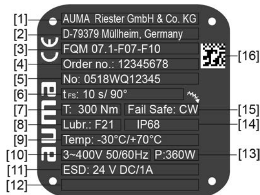
Ábra 2: Fail-Safe egység típustáblája (példa)
