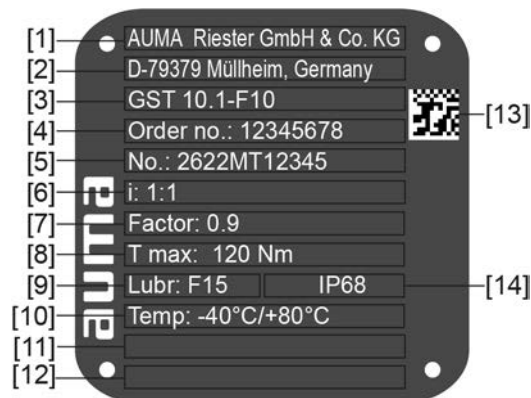
Ábra 2: Fokozómű típustábla (a GST 10.1 típus példáján)
