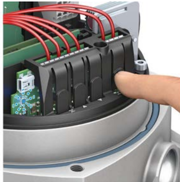
21. ábra: A ZÁRVA végállás beállítása (I/O-interfész példa)
