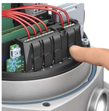
22. ábra: A ZÁRVA végállás beállítása (I/O-interfész példa)
