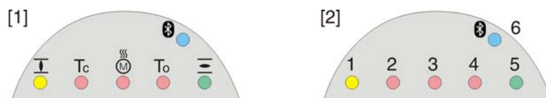
Kép 53: A jelzőfények elrendezése és jelentése
