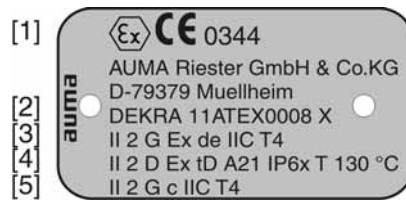
Kép 4: Robbanásvédett kivitel vizsgálati tábla
