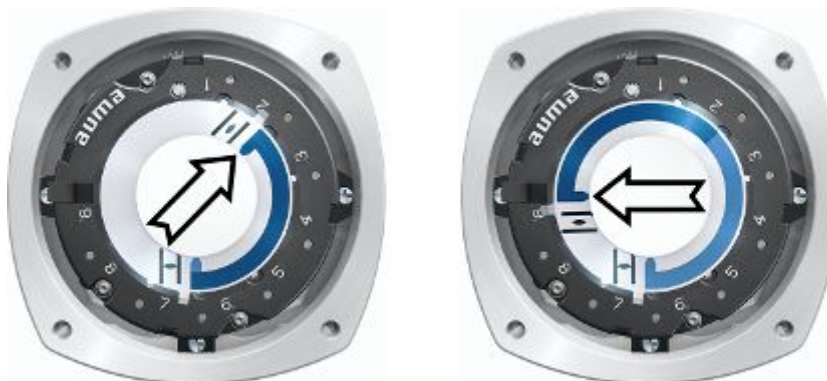
84. ábra: Menet NYITVA helyzetbe (balra) és NYITVA állás (jobbra)
