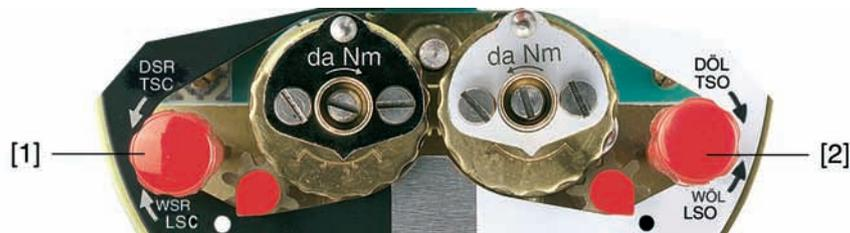
1. Testknopf [1] in Pfeilrichtung DSR drehen: Drehmomentschalter ZU löst aus. Die rote Meldeleuchte (Störung) auf der Ortssteuerstelle leuchtet.
